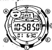
Die Hintergrundleuchte verwendet ein elektrolumineszentes (EL) Panel, welches das gesamte Display beleuchtet, sodass es auch im Dunkeln abgelesen werden kann. Der automatische Beleuchtungsschalter dieser Armbanduhr schaltet die Hintergrundleuchte automatisch ein, wenn Sie die Armbanduhr unter einem bestimmten Winkel gegen Ihr Gesicht halten.
