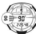
Par exemple, un pointeur de nord magnétique dirigé vers "90" sur le cadran de la montre indique que la position 12 heures est à 90 degrés du nord magnétique (12 heures indiquent par conséquent l'est).
