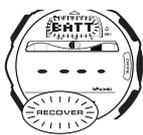
Ce message apparaît lorsque la charge des piles est trop faible et le relevé souhaité impossible. Il apparaît lorsque la charge des piles atteint un certain niveau, ou lorsque vous essayez d'effectuer des relevés à très basses températures (en dessous de  $-10^{\circ}\text{C}/14^{\circ}\text{F}$ ).
