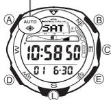
Le rétroéclairage emploie un panneau EL (électroluminescent) qui éclaire tout l'afficheur pour le rendre mieux visible dans l'obscurité. L'autocommutateur d'éclairage de la montre allume automatiquement le rétroéclairage lorsque vous tournez la montre vers votre visage.
