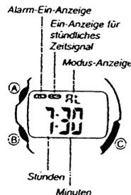
Wenn der tägliche Alarm eingeschaltet ist, ertönt der Alarm täglich zum voreingestellten Zeitpunkt für 20 Sekunden. Wenn das stündliche Zeitsignal eingeschaltet ist, gibt die Armbanduhr zu jeder vollen Stunde einen Piepton aus.
