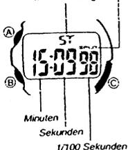
Der Stoppuhr-Modus läßt Sie die abgelaufene Zeit, die Zwischenzeiten und zwei Endzeiten messen. Der Bereich der Stoppuhr reicht bis zu 59 Minuten und 59,99 Sekunden.
