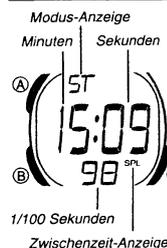
Der Stoppuhr-Modus läßt Sie die abgelaufene Zeit, die Zwischenzeiten und zwei Endzeiten messen. Der Bereich der Stoppuhr reicht bis zu 59 Minuten und 59,99 Sekunden.
