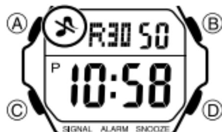
Il segnale acustico di pressione tasti suona ogni volta che si preme uno dei tasti dell'orologio. È possibile attivare o disattivare il segnale acustico di pressione tasti come desiderato.
