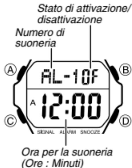
È possibile impostare cinque suonerie quotidiane indipendenti. Quando una suoneria è attivata, il segnale acustico della suoneria suona quando viene raggiunta l'ora fissata per la suoneria. Una delle suonerie è una suoneria a ripetizione, mentre le altre quattro sono suonerie per 1 volta.
