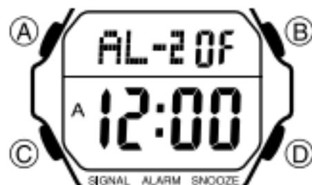
1. Nel modo di suoneria, usare (D) per scorrere le schermate di suoneria finché viene visualizzata quella della suoneria per cui si desidera impostare l'ora.
