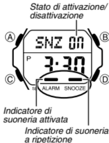
1. Nel modo di suoneria, usare (D) per selezionare una suoneria.
