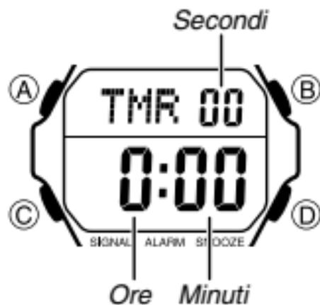
Il timer per il conto alla rovescia può essere impostato nella gamma compresa fra 1 minuto e 24 ore. Quando il conto alla rovescia giunge a zero, una suoneria suona.
