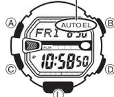
La montre a deux panneaux EL (électroluminescents) qui éclairent tout l'afficheur pour qu'il soit mieux visible dans l'obscurité. L'autocommutateur d'éclairage de la montre allume automatiquement l'éclairage lorsque vous dirigez la montre vers votre visage pour la regarder.
