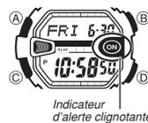
Lorsque l'alerte clignotante est activée, l'éclairage clignote pour les avertisseurs, le signal horaire, l'avertisseur de compte à rebours et le démarrage automatique du chronomètre (ST1).
