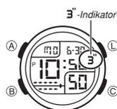
Das Display der Armbanduhr wird von einer lichtemittierenden Diode (LED) und einem Lichtleitpanel beleuchtet, damit Sie dieses auch im Dunkeln einfach ablesen können.
