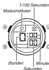
Die Stoppuhr lässt Sie die abgelaufene Zeit, Zwischenzeiten und zwei Endzeiten messen.
