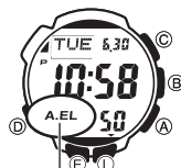
Indicateur de commutateur d'éclairage automatique en service
