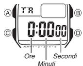
Il timer per il conto alla rovescia può essere impostato nella gamma compresa tra 1 minuto e 24 ore. Quando il conto alla rovescia giunge a zero, una suoneria suona.
