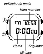
O timer de contagem regressiva pode ser especificado dentro de uma faixa de 1 segundo a 24 horas. Quando a contagem regressiva atinge zero, um alarme soa durante 10 segundos ou até que você pressione um botão.
