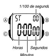
El cronógrafo le permite medir el tiempo transcurrido, tiempos fraccionados y dos llegadas a meta.
