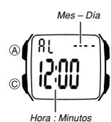
La alarma multifunción le permite especificar la hora, minutos, mes y día para la alarma (página S-10). Puede ajustar la alarma de manera que suene una vez cuando se alcanza la hora de alarma, o para una alarma de despertador que se repite hasta siete veces, a cada cinco minutos.
