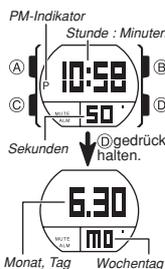
Verwenden Sie den Zeitnehmungsmodus zum Einstellen und Ablesen der laufenden Uhrzeit und des Datums. Bei eingeschalteter Active-Display-Funktion zählt die Uhr mit, wie oft Sie sie zum Ablesen auf das Gesicht richten oder den Arm anderweitig bewegen. Die Uhr wählt dann je nach aufgelaufenem Zählwert für die Uhrzeitanzeige im Zeitnehmungsmodus automatisch einen von sechs verschiedenen Anzeigestilen.
