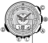
Dénivélé indiqué par la trotteuse
